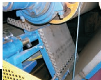
Пример установки воздушного транспортера в конце бумагоделательной машины
