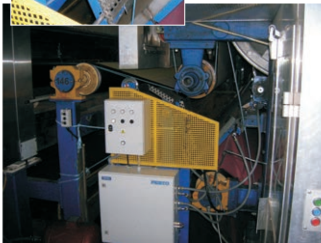
Пример установки воздушного транспортера в конце бумагоделательной машины
